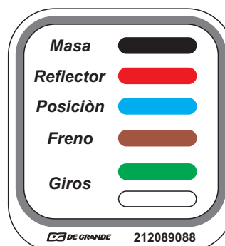
Identificación de conexión eléctrica de las luminarias del equipo.
